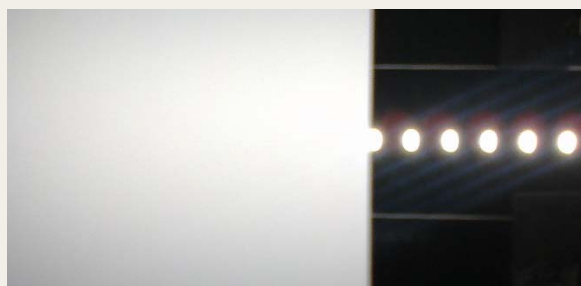
III. 3 : Rampe lumineuse avec LED espacées de 8 mm. Cache de protection à 10 mm de distance.
